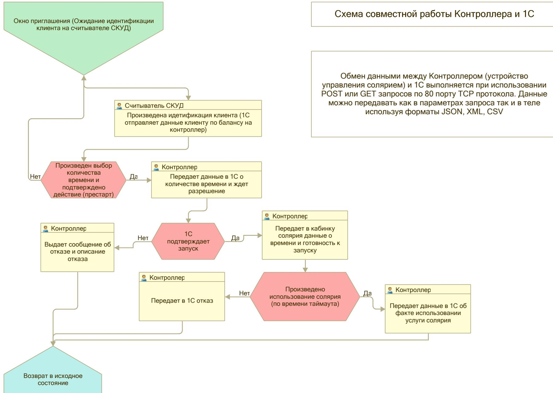
Обмен данными между Контроллером (устройство управления солярием) и 1С выполняется при использовании POST или GET запросов по 80 порту TCP протокола. Данные можно передавать как в параметрах запроса так и в теле используя форматы JSON, XML, CSV
